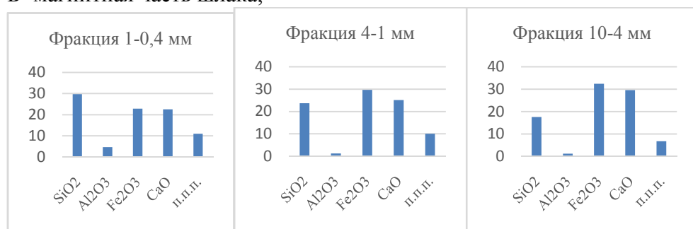
В – состав шлака до магнитной сепарации
